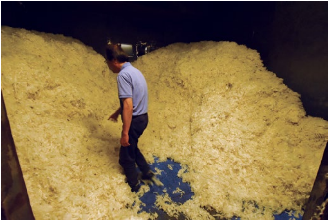
調合室には1トンの材料が入る。何色もの原料にオILINGして調合し、カード機に送り出す。
